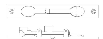
Pasador de embutir a palanca para puertas y ventanas de rebatir. Con freno de 25 cms.
