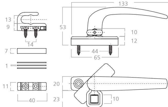
Aldaba para ventanas desplazable de abrir con apoyo a rodillo, base y contratrabas con tornillos ocultos.
