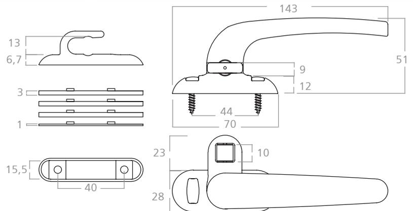
Aldaba para ventanas desplazable de abrir con apoyo a rodillo, base y contratrabas con tornillos ocultos.
