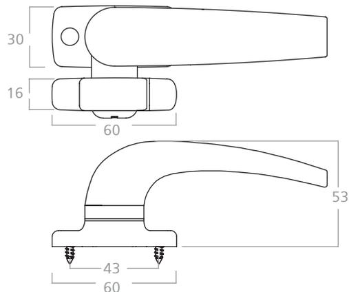
Aldaba para ventanas desplazable de abrir con apoyo a rodillo
