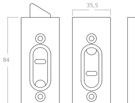
Trabas laterales para sostener las hojas y permitir el volcado en las ventanas guillotinas.
