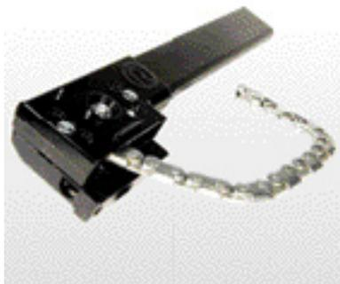
Accionador reversible a cable y cadena para ventanas de proyección y banderolas. Abertura no superior de 1/3 de la altura. Para más de 1.500 mm. de ancho, se deben colocar dos. Pueden accionar varios al mismo tiempo.
