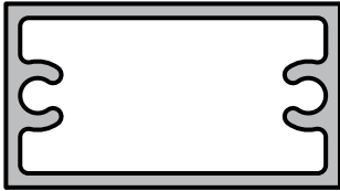
PARANTE REFORZADO Perfil: 2637 Peso: 0,648 Kg/m
