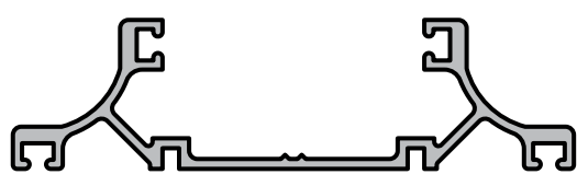
TAPA COLUMNA Y TERMINACION PARED Perfil: 4362 Peso: 0,505 Kg/m
